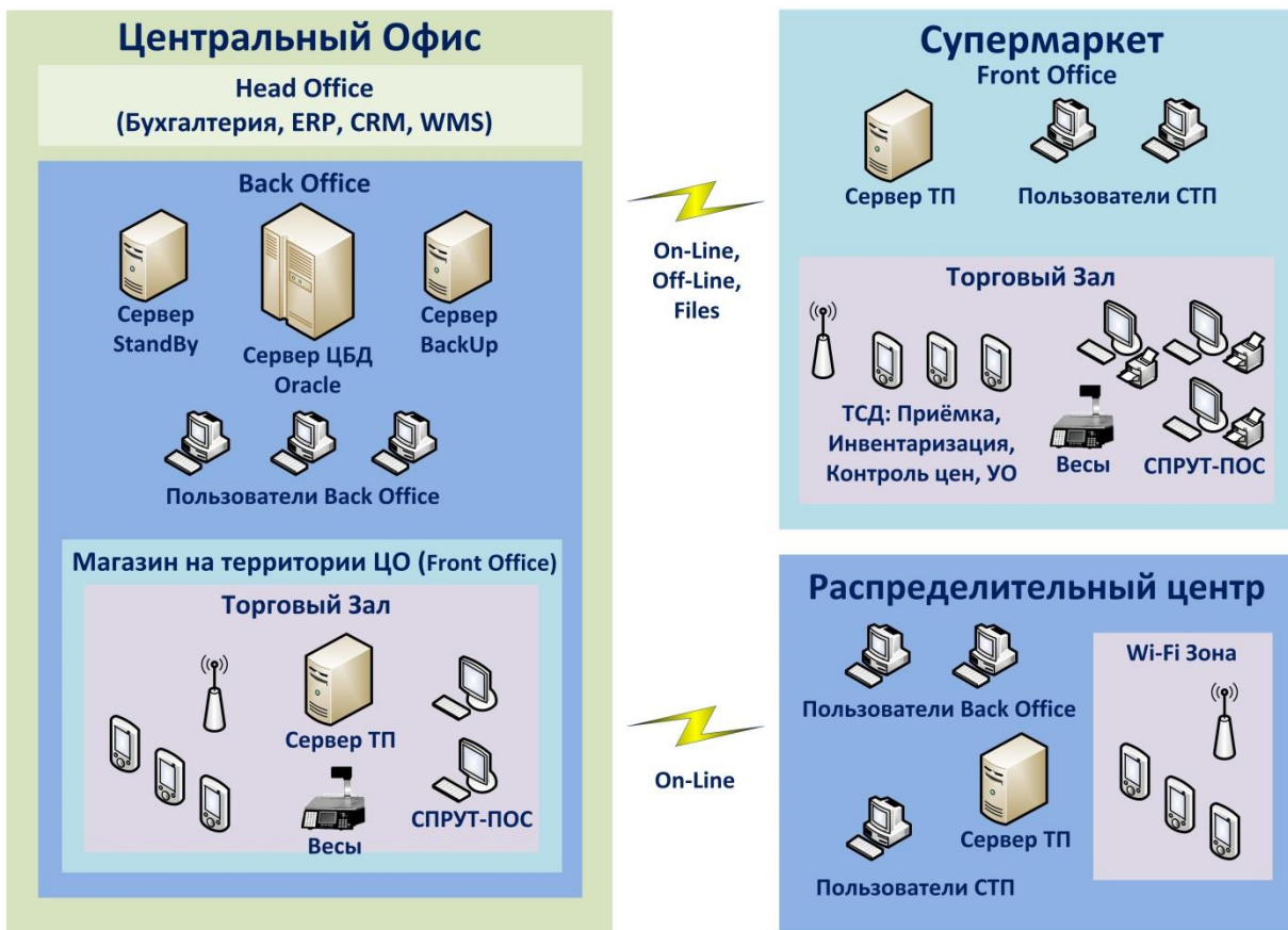
Топологическая схема ПС СПРУТ
